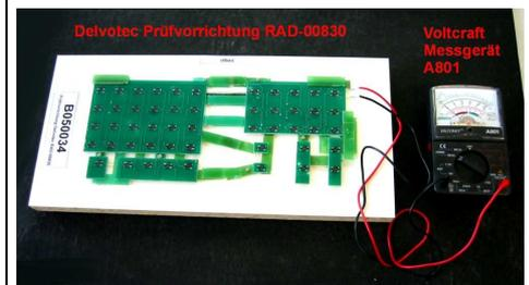
3. Der Messbereich des Voltcraft Messgerät (B050036) ist auf OHMS und RX10 einzustellen.
